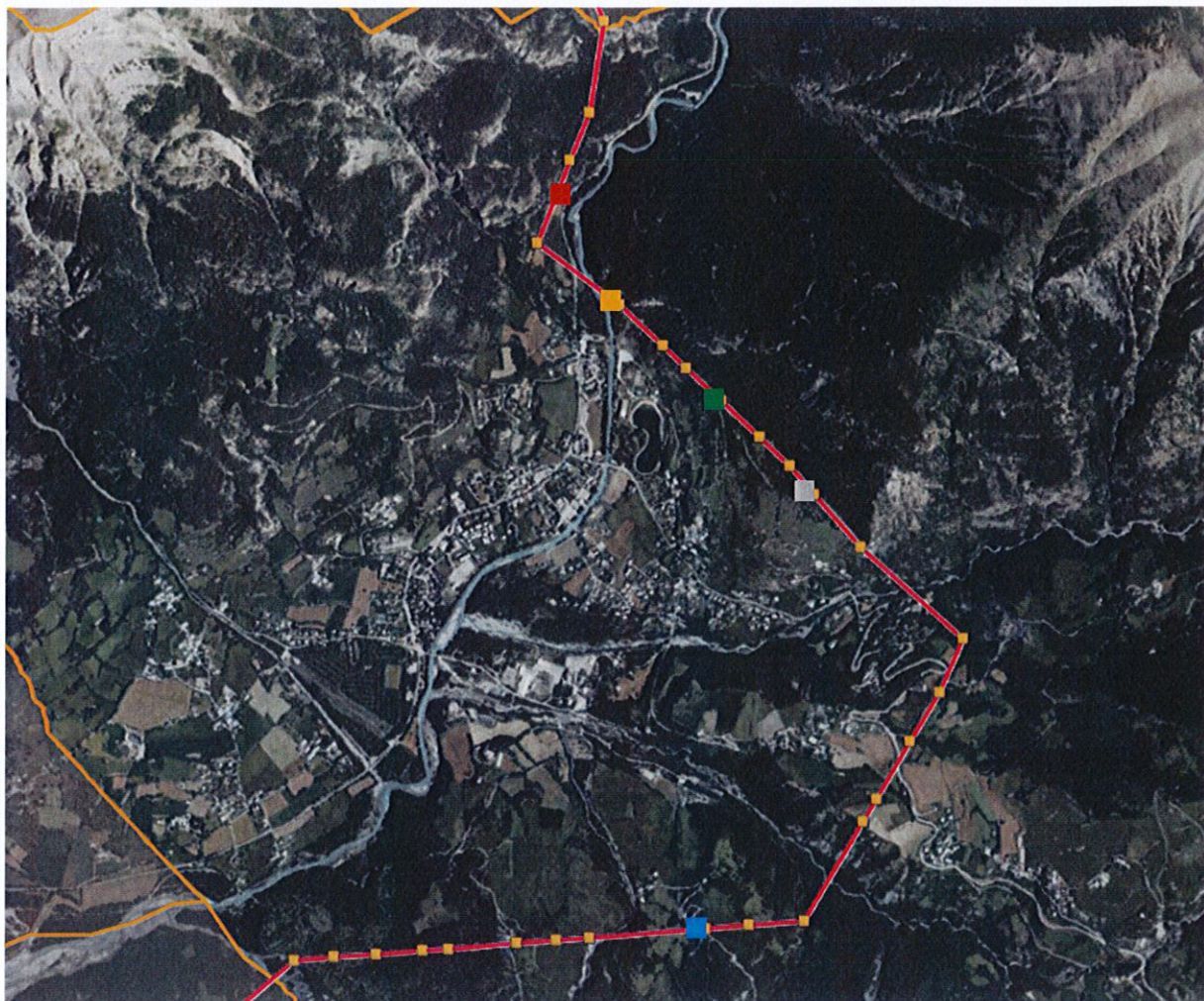
Illustration du tracé de la ligne HTB sur le territoire communal et des supports prévus au remplacement par RTE
