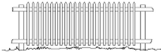
Clôture type de montagne (palisson).
